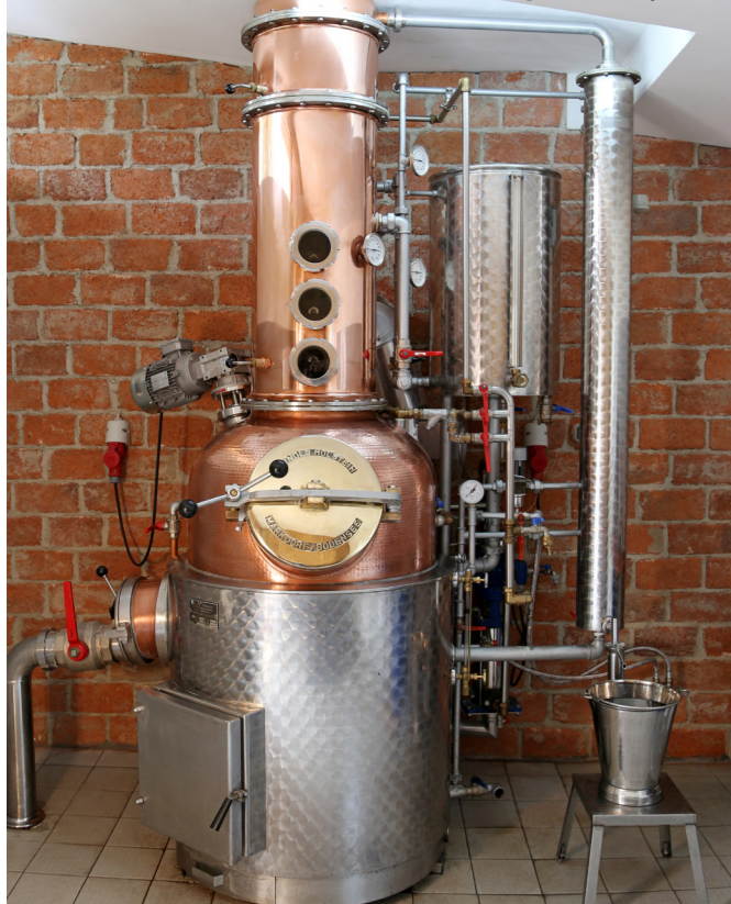
Brennanlage mit Katalysator.
